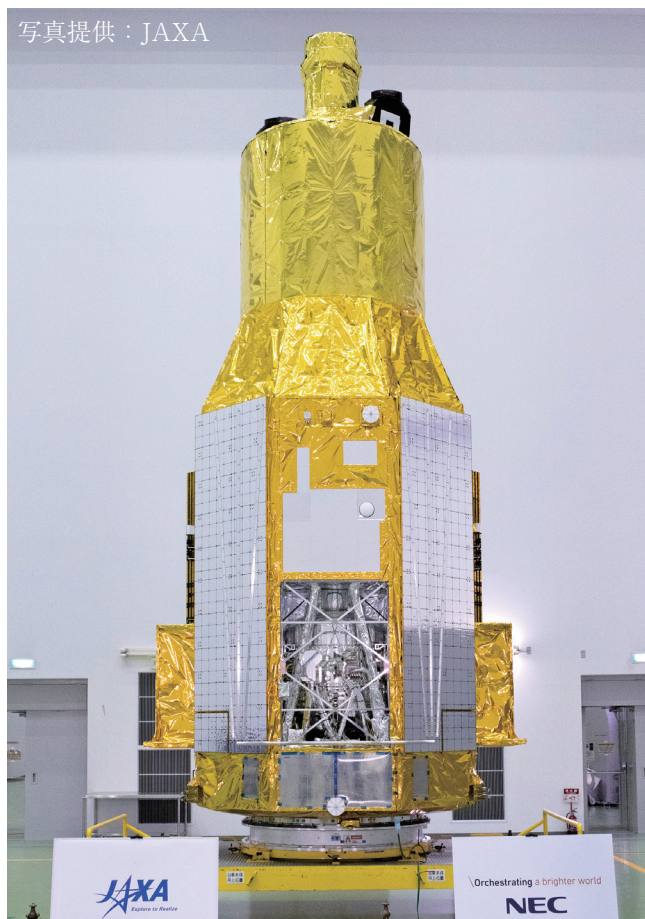
図：XRISM衛星機体。機体下側の格子窓越しに見えるのがResolveカメラ
