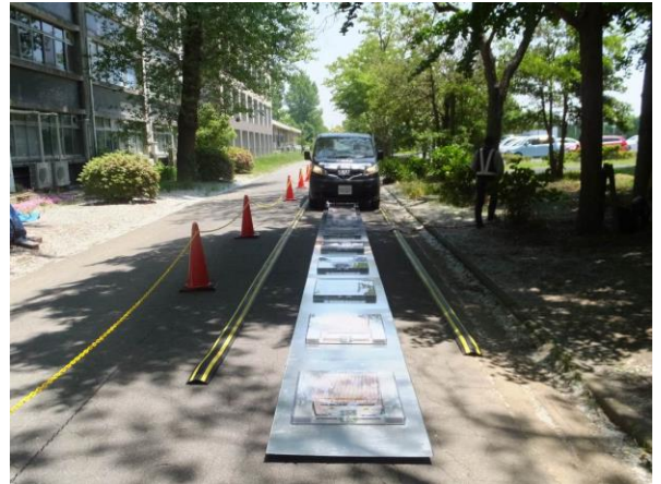
走行中ワイヤレス給電システム
