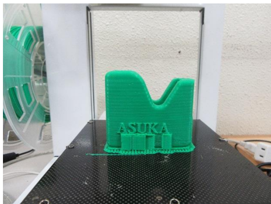
写真3 3Dプリンターによる3Dモデルの出力例
