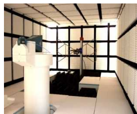
電波暗室 (アンテナ測定)
