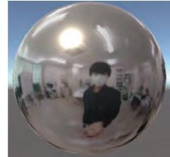
モバイル端末の前面カメラで撮影した画像を外挿し、360°のパノラマ画像を生成することで、金属物体への周囲環境の映り込みを再現する。
