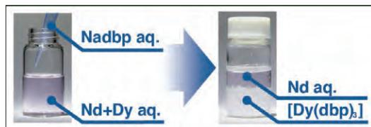
1段階の操作で  $Dy^{3+}$  のみが沈殿
