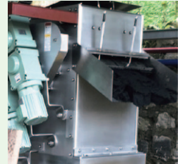
弊社高分子凝集剤を用いたインドネシア食品工場廃水の脱水
