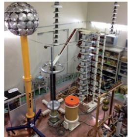
図2 AC・DC・インパルス高電圧試験装置
