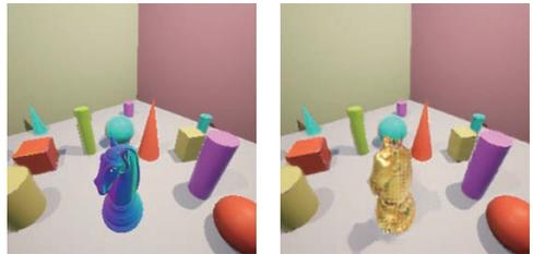
与えられた背景画像と仮想物体の法線画像のみから光源情報を暗黙的に推定し、物体の反射と影を再現する
