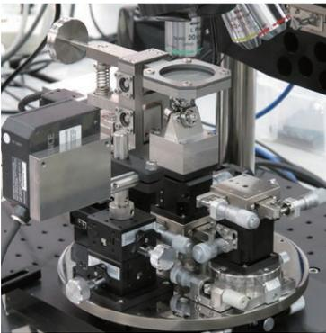
＜光干渉法の高精度油膜計測装置＞
