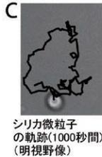
A: 架橋した微小管をキネシンで駆動する「運動ゲル」、B: ゲルの蛍光像、C: 揺らぎで動かす微粒子の軌跡
