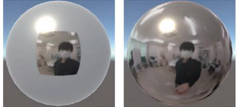
モバイル端末の前面カメラで撮影した画像を外挿し、360°のパノラマ画像を生成することで、金属物体への周囲環境の映り込みを再現する。
