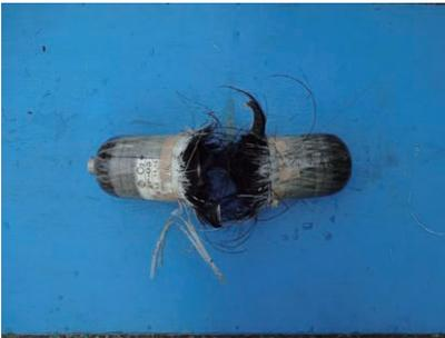
破裂した複合圧力容器
