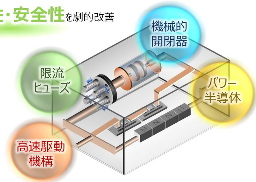
電力機器・半導体・精密位置決め制御技術の粋を結集した新しい遮断器
