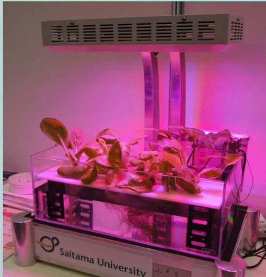
植物生体電位応答を用いた光源自動制御水耕栽培システム
