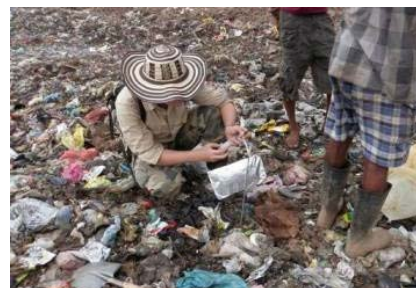
スリランカ廃棄物処分場における 埋設ガスサンプリング
