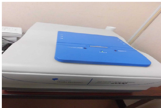
設備マスタープランに基づき更新した ゼータ電位・粒径測定システム
