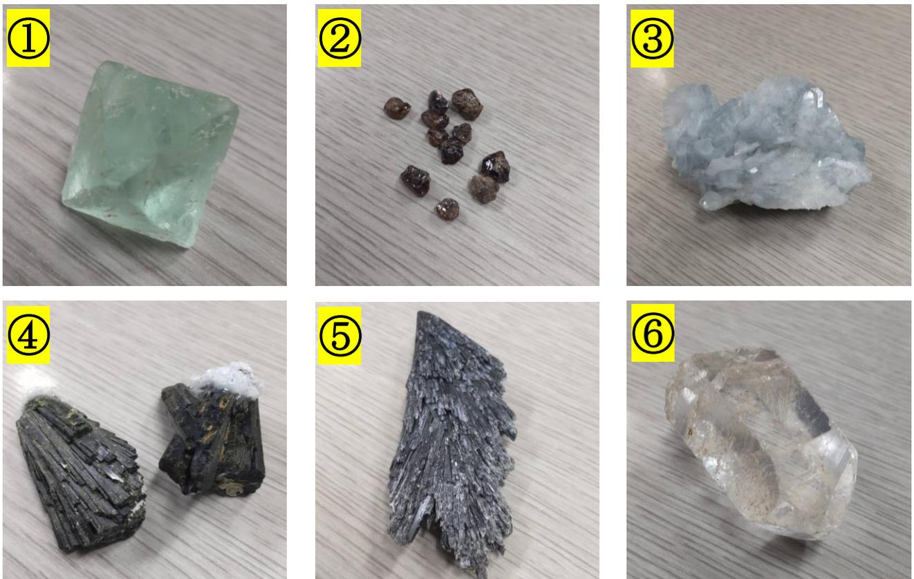
図2：6つの結晶系に該当する鉱物 ①蛍石 (等軸晶系) ②ジルコン (正方晶系) ③重晶石 (直方晶系) ④緑簾石 (単斜晶系) ⑤藍晶石 (三斜晶系) ⑥石英 (六方晶系)
