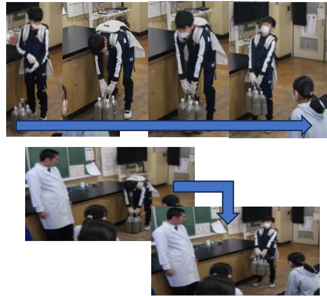
図5 第7時間目にアシストスーツを着用して重い物を持ち上げる様子(上:電源を入れていない状態) (下:電源を入れた状態)
