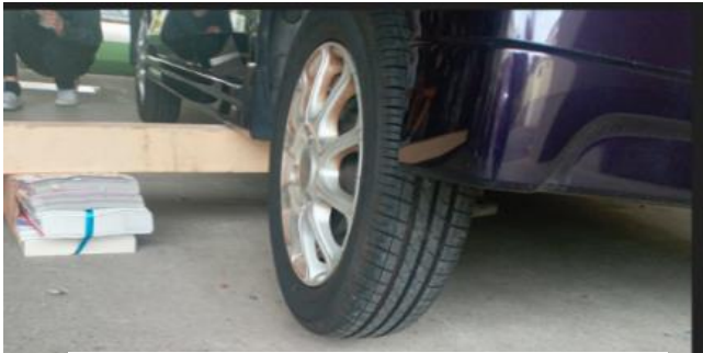
図 2 導入時にタイヤを浮かせている様子
