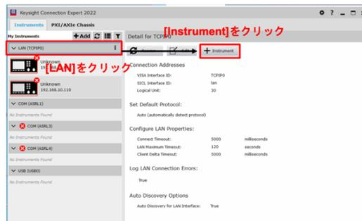
写真7 Add a LAN deviceのウィンドウの画面
