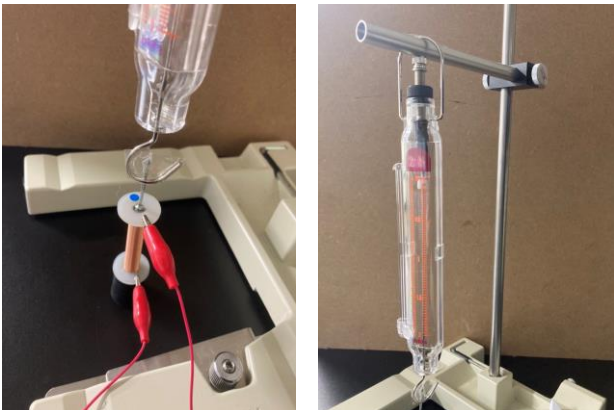
図4 磁場の大きさと力の関係の実験配置
