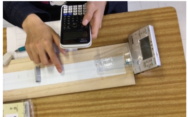
図15 関数電卓を用いてモノコードの弦の長さを探し、チューナーを用いて調律している様子
