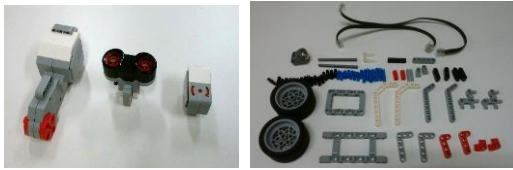
図2 各種センサーやモーター (左) と タイヤ等のパーツ (右)
