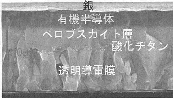
(図2) ペロブスカイト太陽電池断面の電子顕微鏡像
