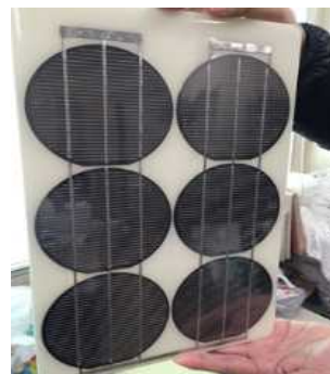
A4サイズ太陽電池モジュール試作品
