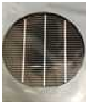
4インチ塗布型太陽電池試作品
