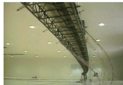
明石海峡大橋の模型を用いた風洞実験(本四公団提供)
