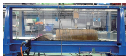
多重防御構造を模した水理模型を使った実験の様子。装置内に波を起こし、堤防(左の隆起した部分)と海岸林(右側の棒状のものが並ぶ部分)が及ぼす影響を調べます
