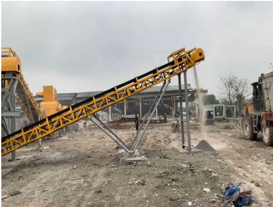
再生コンクリート路盤材製造のための設置型破碎機(ベトナム初) 19
