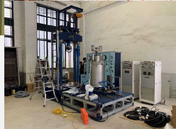
再生路盤材力学試験機 大型三軸圧縮試験機 (ベトナム初)
