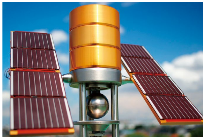
ソーラー磁気浮上実験装置
