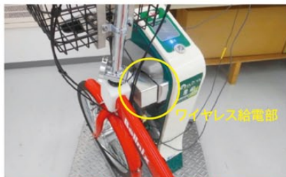
レンタル自転車のワイヤレス給電装置(2016年3月実証実験時)
