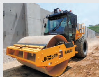
次世代機 自動走行ローラーの試作機
